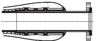
Raccordi vulcanizzati e rivestiti a flangia fissa; UNI - ASA - D.I. 1882 ecc.
