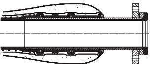
Raccordi vulcanizzati e rivestiti a flangia mobile; UNI - ASA - D.I. 1882 ecc.
